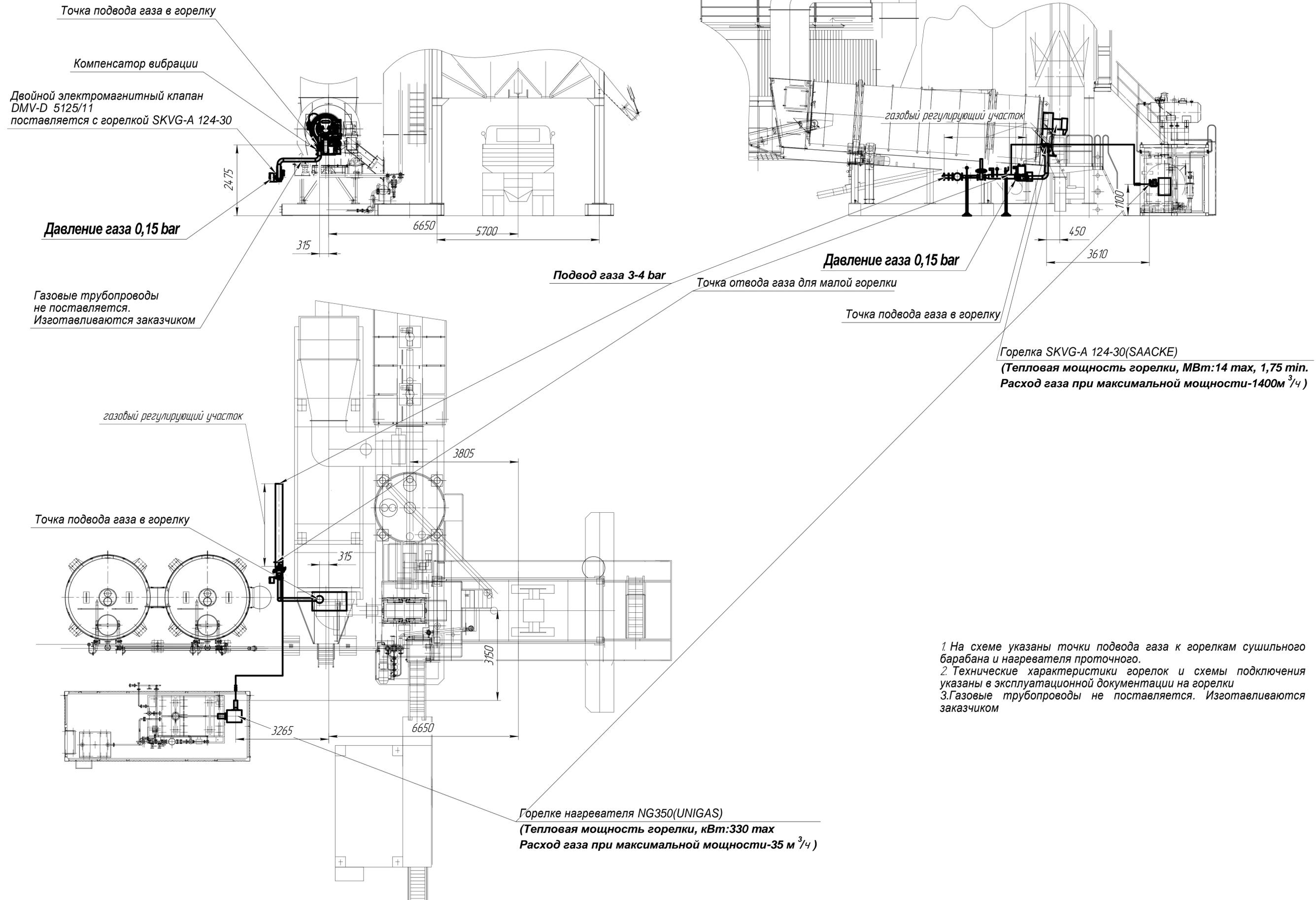
1. На схеме указаны точки подвода газа к горелкам сушильного барабана и нагревателя проточного.
